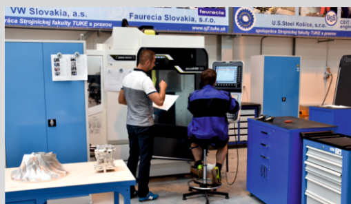
5-osá CNC frézovačka - stroj pre najzložitejšie dielce
